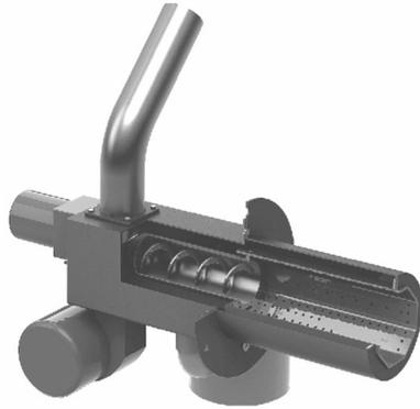
*Schema 2. Konstruktion von Pelletbrenner*
